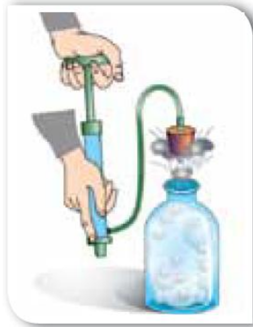
Мал. 26. Дослід із зменшення внутрішньої енергії повітря за рахунок виконання ним роботи
